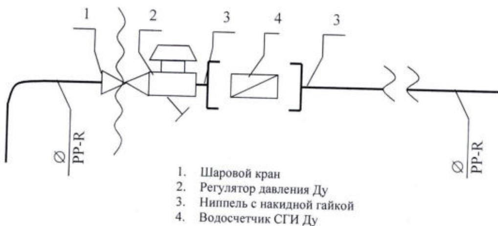
Исполнитель несет ответственность за надлежащее состояние и работоспособность систем горячего и холодного водоснабжения согласно нижеуказанной схеме до волнистой линии слева (включая шаровой кран).
